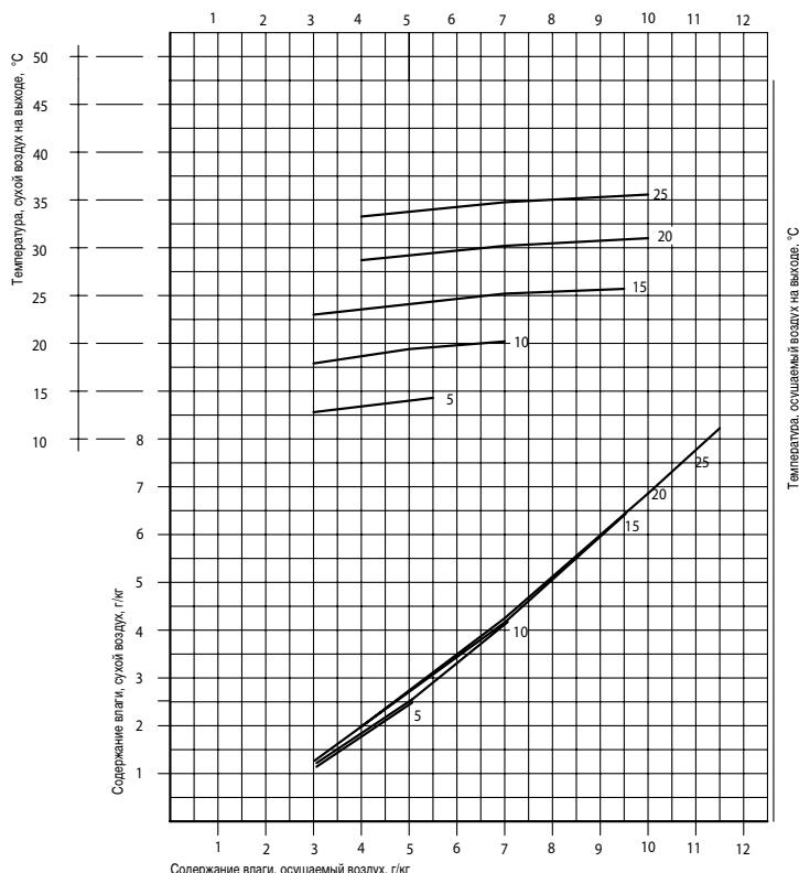
Рис. 20. Кривые влагосъема для осушителя серии AD 400 В.
