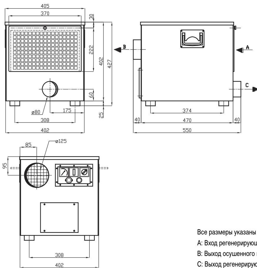
Рис. 15. Габаритный чертеж осушителя AD 290 B.
