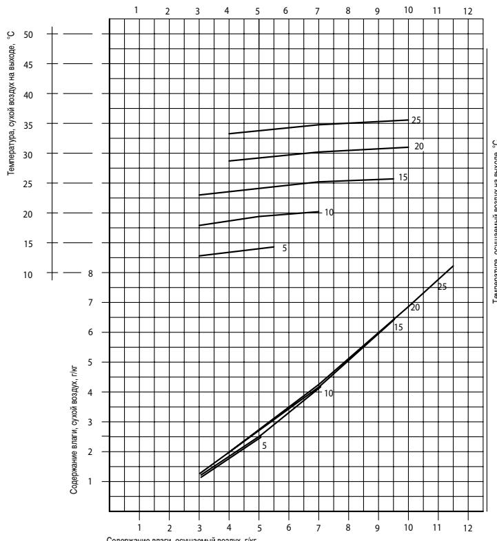
Рис. 18. Кривые влагосъема для осушителя серии AD 240 B.
