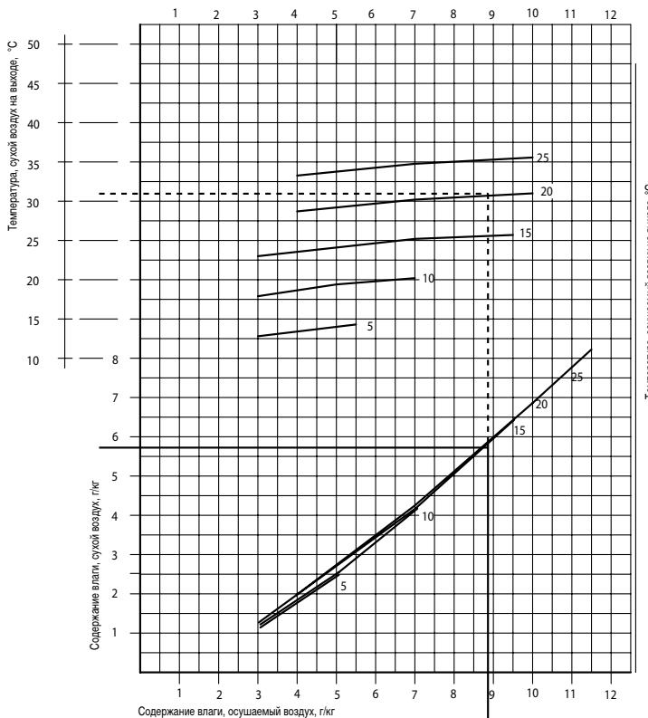
Рис. 21. Пример расчета производительности для осушителя AD 120 B.
