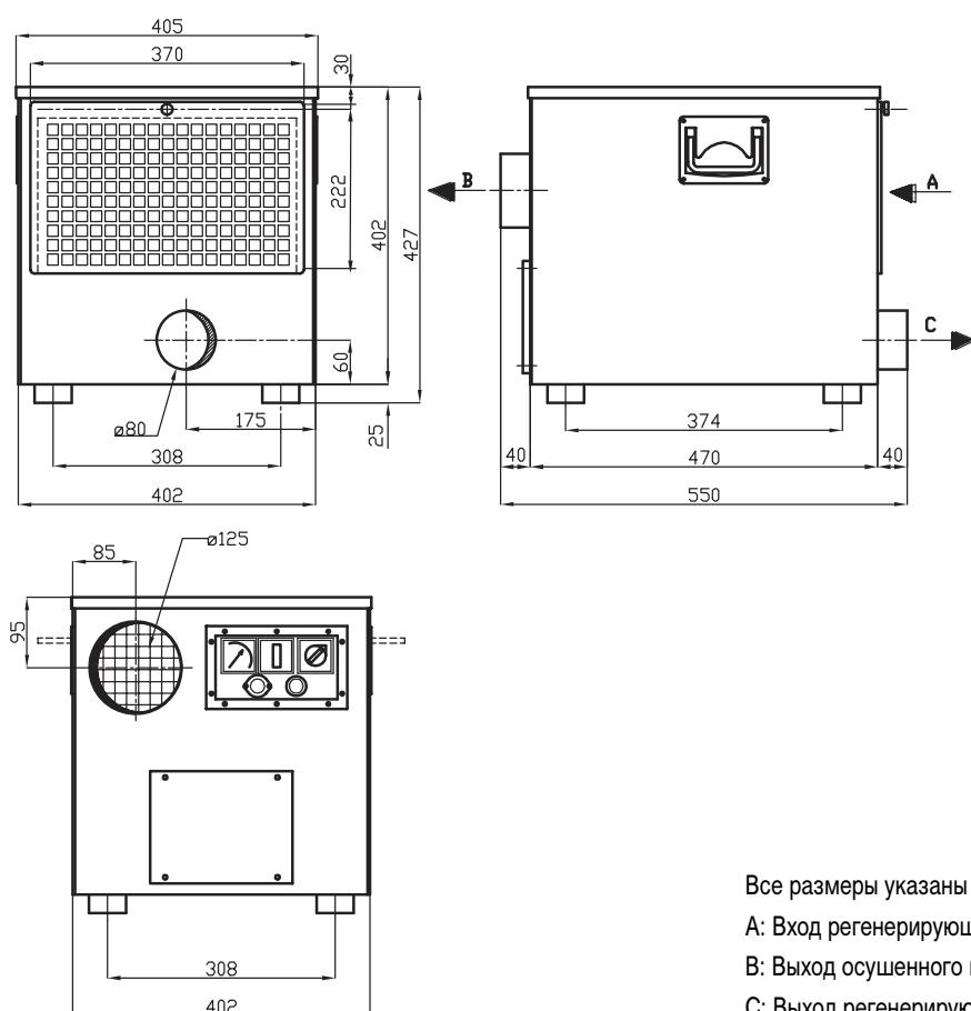
Рис. 16. Габаритный чертеж осушителя AD 400 B.
