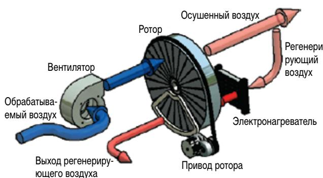
Рис. 7. Принцип действия осушителей AD 120...400 В.
