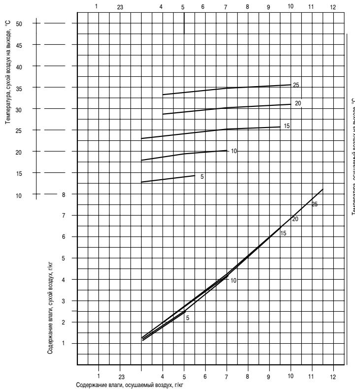
Рис. 17. Кривые влагосъема для осушителя серии AD 120 B.
