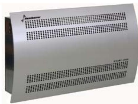
В систему управления осушителей CDF 35 и CDF 45 входит встроенное активное устройство защиты от обмерзания. Через 30 минут после регистрации датчиком испарителя начала обледенения испарителя происходит автоматическое переключение осушителя на режим оттаивания, во время которого горячий хладагент, минуя конденсатор, проходит непосредственно через испаритель.
