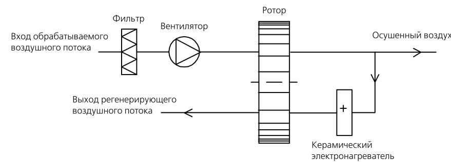
Рис. 8. Принципиальная схема осушителей AD 120...400 В.
