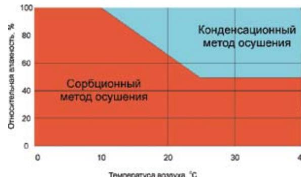
Рис. 5. Преимущественные области использования различных методов осушения
