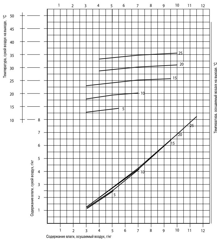
Рис. 19. Кривые влагосъема для осушителя серии AD 290 В.
